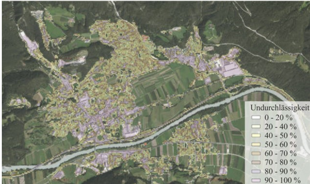
Abbildung 55 Versiegelung (Undurchlässigkeit) im Gemeindegebiet von Telfs; dicht bebauter Ortskern und Gewerbegebiete, Wohngebiete mit deutlich geringerer Dichte (Ein- und Mehrfamilienhäuser)
